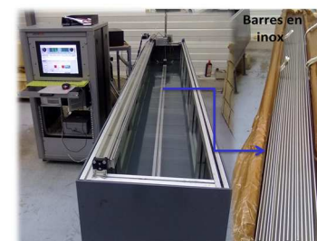
Contrôle de défauts sur des tubes en inox
