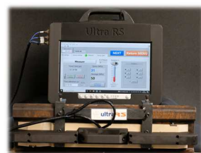
Mesure de contraintes sur Rails
