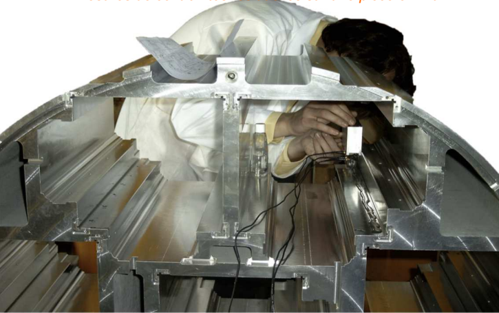
Mesures de contraintes résiduelles sur une pièce en Alu
