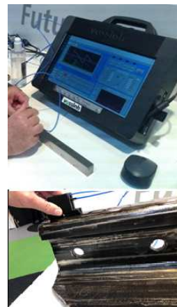
Détection de défauts-Acier Manganese
