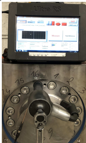
Serrage contrôlé par ultrason
