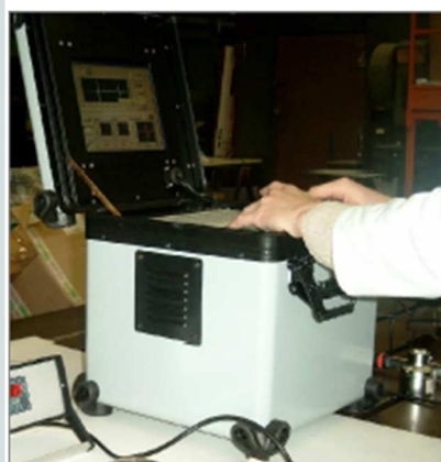
Exemple de dispositif de mesure de la profondeur de nitruration dans des bagues de roulement de moteur d'avion
