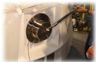
Le serrage contrôlé par ultrason est l'une des spécialités d'ULTRA RS. Notre technologie de pointe permet une mesure précise de la force de serrage sur les vis ou goujons par ultrasons.
