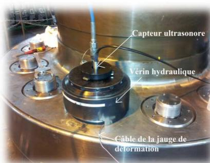
Lors de son serrage, deux effets vont faire augmenter le temps de parcours. L'effet acoustoélastique tout d'abord, qui est l'effet direct provoqué par la contrainte de traction dans la vis. Celui-ci tend à diminuer la vitesse de propagation de l'ultrason et, par conséquent, à augmenter son temps de vol. Ensuite, l'effet d'allongement de la vis, qui a un impact sur le chemin parcouru par l'onde et ainsi tend à faire augmenter son temps de propagation.
